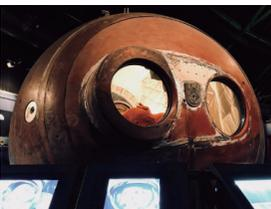
該東方太空艙是進行過實際飛行，並從宇宙返回的太空艙實物。再入大氣層時，表面因為摩擦而發生燃燒。返回用太空艙供1人乘坐，再入大氣層之前，與機械艙分離。在距離地面約6,000m的高度處，宇航員跳出該艙，與艙分離。艙和宇航員分別通過降落傘返回地面。
