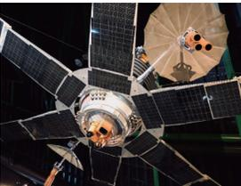
該Molniya通訊衛星是前蘇聯為覆蓋整個寬闊的俄羅斯大陸而成功開發的通訊衛星，能夠確保地面與遠地點之間的距離並穩定飛行，「Molniya」是“閃電、緊急電報”的意思，該通訊衛星的特徵在於：主體內部搭載了大型陀螺儀，從而實現了穩定化。這裡展示的通訊衛星為Molniya 1號的備用機。
