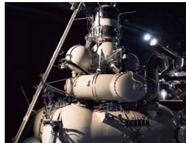
1976年8月，前蘇聯進行了最後一次探月計劃『月球計劃』。該計劃所用飛船為月球24號。這裡展示的月球24號為實物的備用機，一旦實物發生故障，可立即改用該備用機。該計劃為：以無人的方式登陸月面，利用地球對登月艙進行的控制，使連接於左側的鑽頭在月面開孔，採集土樣，並將採集到的土樣密封於頭部球形艙內，再次將第2段向地面發射，最終，僅球形艙返回地面。
