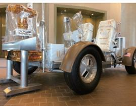
這裡展示的月球車（月面車）再現了阿波羅15號所搭載的月球車，為了能夠在地面上行駛，將金屬絲網輪胎更換成了橡膠輪胎。在地面使用時，如果2個人乘坐，在月球表面上可以承受1/6重量的金屬輪胎就會凹陷，因此不適用於地面行駛。該月球車由蓄電池驅動，在地面上的最高時速可達約30km。可依靠位於中央的手柄，控制前進、後退、左右行駛。
