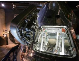
該阿波羅司令艙呈圓錐形，底部直徑3.1m、高3.23m、重5.9t，供3人乘坐。內容積僅10立方米，大小與超小型汽車相似，通常在這樣狹窄的空間中活動比較困難，但由於處於無重力狀態，故能夠適當活動。大小共計有5個窗口，和這裡所展示的一樣，表面貼有耐熱膜，再入大氣層前，會發出銀光。該司令艙盡可能地採用了與實際所用部分相同的部件、素材組裝而成。
