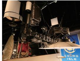
該航海家行星探測船的測量磁力用吊桿等細節採用了與實際相同的部件。該吊桿的實際長度達10m以上，但該航海家行星探測船截取自防護筒延伸出的第1段，故吊桿長度沒有10m。外部覆蓋的護罩等的材質與實物相同。再者，連接於主體側面的金色圓盤板上刻有該航海家行星探測船起飛的地球位置、太陽系位置等，背面為錄音盤，錄製有「你好！你好嗎？」的日語發音。該航海家行星探測船上錄製有我們對尚未發現的E.T.I（外星智能生物）的問候。
