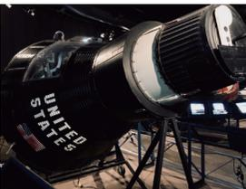
該宇宙飛船是美國開發的單人乘太空艙，是合眾國首個載人飛行用宇宙飛船。當時，用來發射該太空艙的火箭為水星-紅石型、大力神型，皆屬洲際彈道導彈（IRBM）等導彈的改良型裝置。在這裡展示的太空艙外壁上，完全依據實際所用的模型製作了被稱作「Single」的耐用防護罩。此外，內部的開關、測量儀器及並不顯眼的救生包也都真實地再現了當時的情景。
